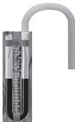
Fig. 38 Manómetro.
