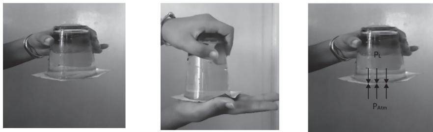
Fig. 37 La presión atmosférica actúa sobre la cartulina que se encuentra colocada sobre el borde superior en el vaso con agua, y este se encuentra invertido.
